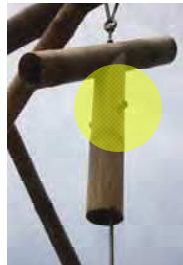
Gambar 11. Proses Pengujian Sambungan Bambu 1
