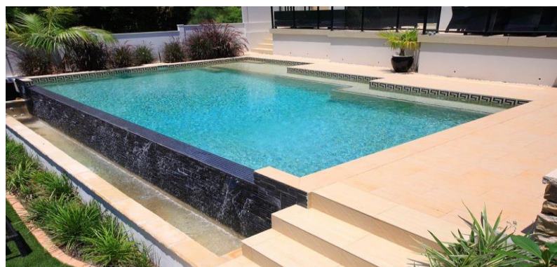
Gambar 2.8 Saluran over flow pada satu sisi kolam
