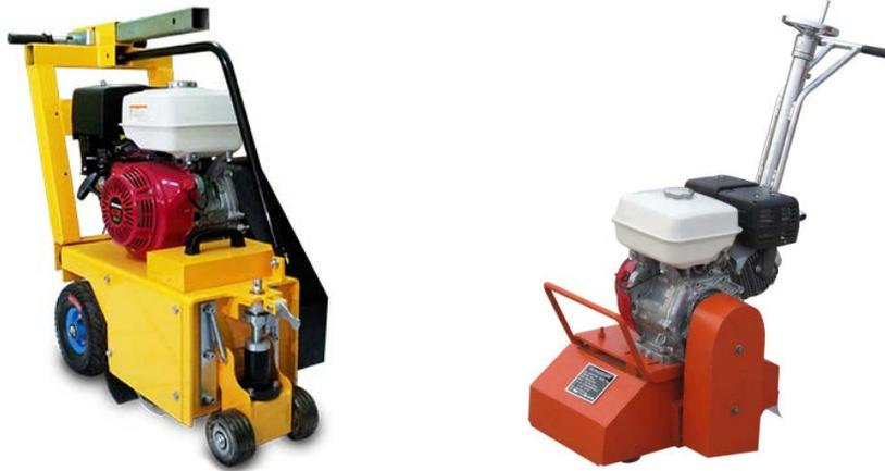
**Gambar 1. Contoh Mesin penghapus marka jalan dorong [3]**
