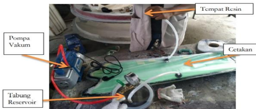
Gambar 13. Hasil perakitan alat Vacuum Infusion
