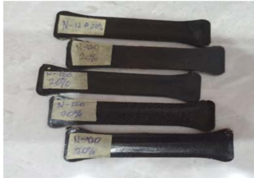
Gambar 2. Spesimen komposit uji bending
