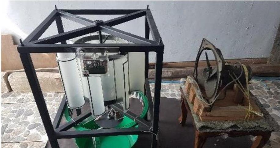
**Gambar 2.** *Setup* pengujian prototip turbin angin yang dipasang alat ukur daya
