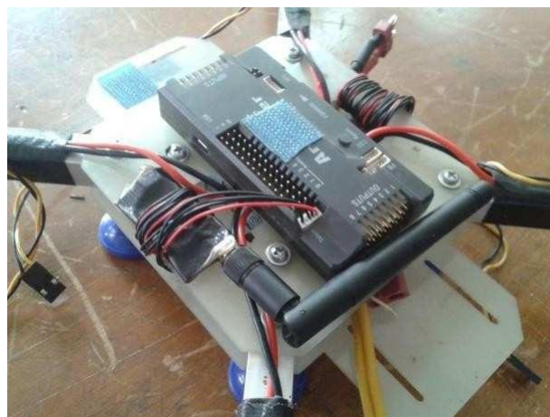
Gambar 2. Kendali terbang dan komponen elektronik generik pada low-budget quadcopter
