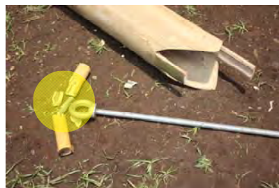
Gambar 12. Kerusakan pada Sambungan Bambu 1 Pasca Pengujian
