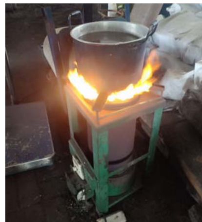
b. Uji coba pembakaran pelet hydropulper reject
