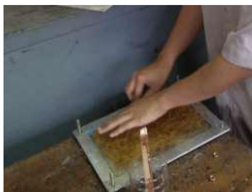
Gambar 3 Proses perataan resin pada serat
