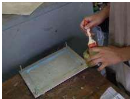
Gambar 2 Proses pelapisan wax pada cetakan
