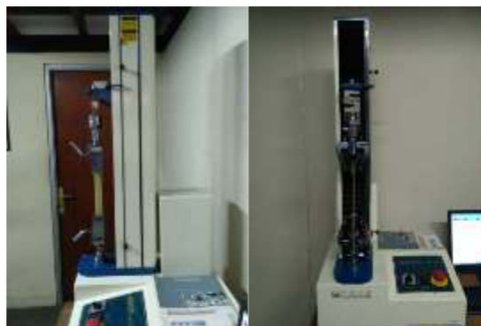
Gambar 6 Posisi Spesimen Pada Mesin Uji Tarik
