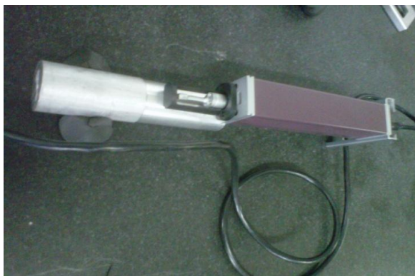
Gambar 2. Pengujian Tingkat Kekasaran
