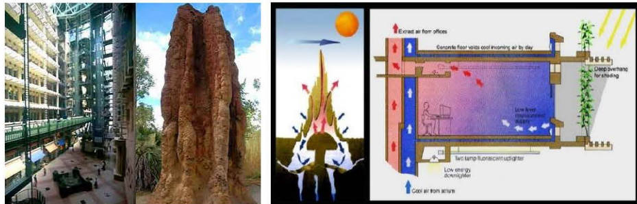
Gambar 2.1 Konsep Pendinginan Bangunan The Eastgate Centre
