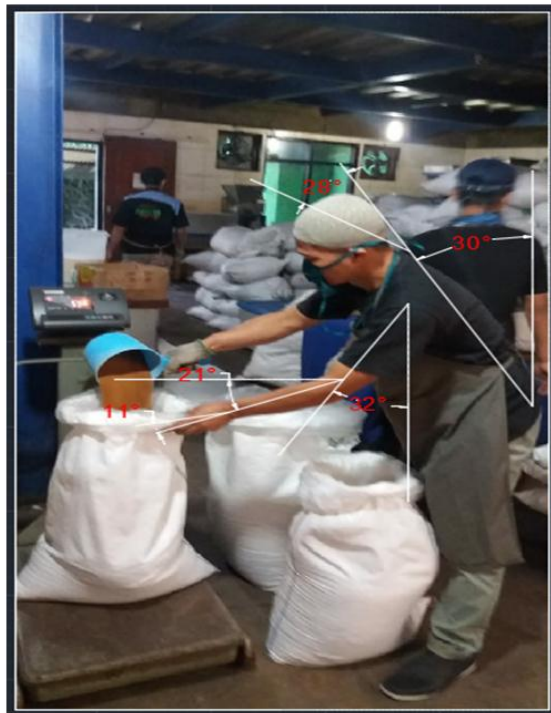
Gambar 1. Posisi Kerja pada Elemen Kerja Menempatkan Bahan Baku dari Karung ke Timbangan
