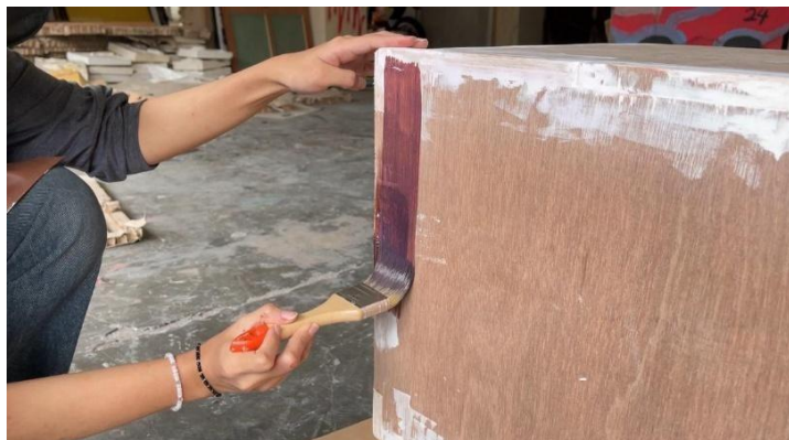
Gambar. 23 dan 24 . Proses Pengaplikasian Varnish Kayu Source : Dokumentasi Pribadi
