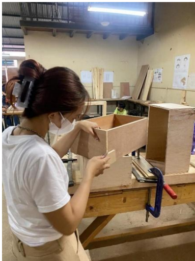
(Gambar 7. Proses mengampelas kotak box mainan) (Gambar 8. Proses membobok sisi kayu untuk dowol)
