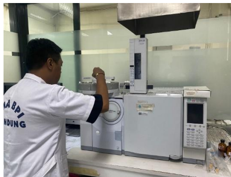
Gambar 4.2 Proses memasukan sampel air kedalam alat GC-MS
