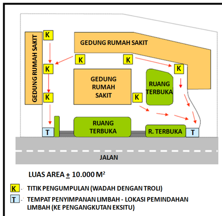
Gambar 3. 4. Contoh tata letak rute sistem pengumpulan Limbah dari kegiatan fasilitas pelayanan kesehatan (Sumber : Menteri Lingkungan Hidup dan Kehutanan RI, 2015)
