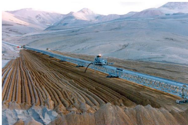
Gambar 2. 2 Tailing Susun Kering Dan Saringan Diangkut Dengan Konveyor dan Dipadatkan Oleh Buldoser
