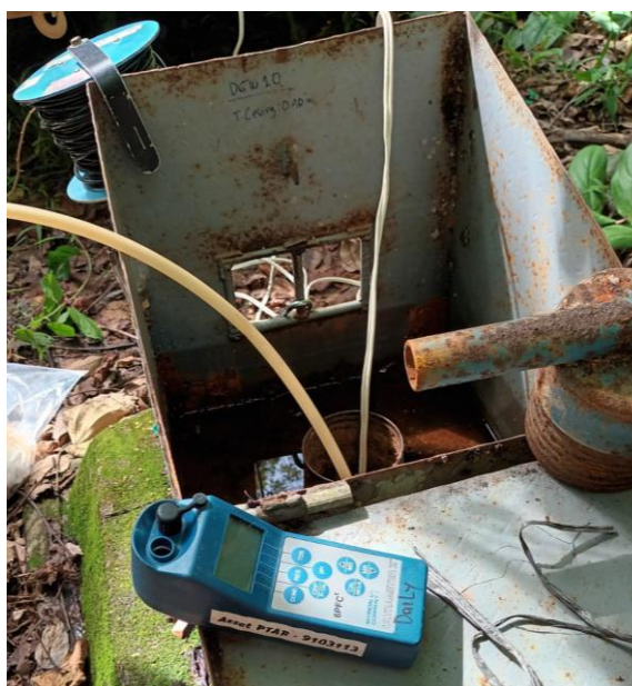
Gambar 3. 21 Pengambilan Sampel Air Tanah di DGW 10
