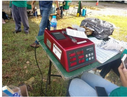
Gambar 3.1 Smoke Opacimeter Alat untuk Mengukur Bahan Bakar Solar
