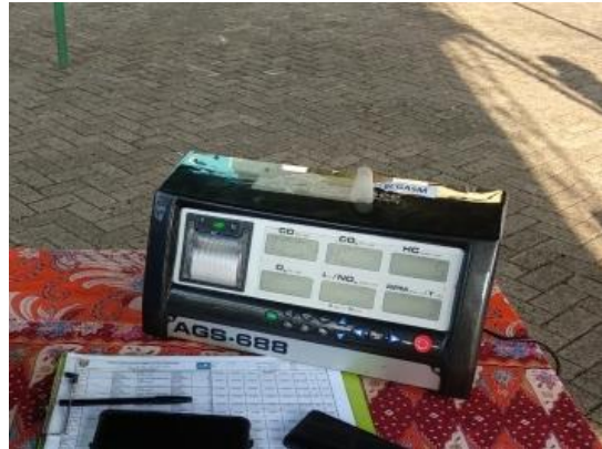
GAMBAR 3.2 MULTIGAS ANALYZER ALAT UNTUK MENGUKUR BAHAN BAKAR BENSIN
