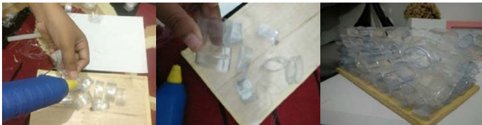
Gambar 10. Desain armatur lampu dari botol air mineral jenis PET dengan teknik pemanasan heat gun dan penyambungan lem panas
