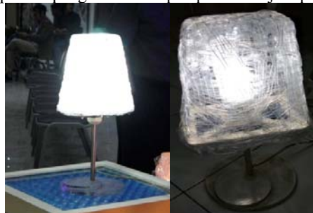
Gambar 12. Prototype armature table lamp dari botol air mineral jenis PET dengan teknik pemanasan heat gun
