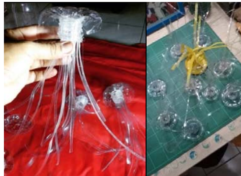
Gambar 7. Desain jelly fish partition dari botol air mineral jenis PET dengan teknik pemanasan heat gun dan penyambungan lem panas
