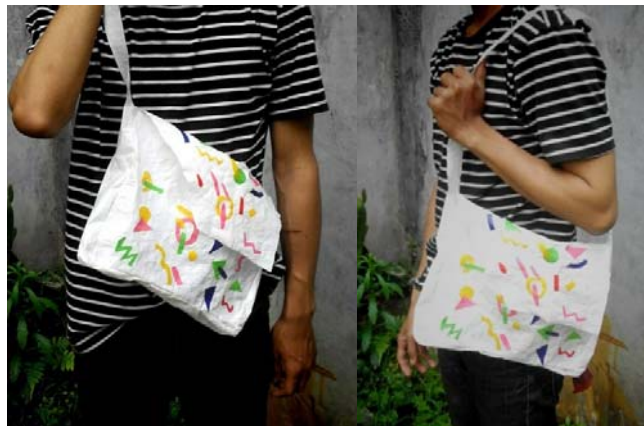
Gambar 15. Prototype Tas dari kantong kresek jenis HDPE dengan teknik pemanasan setrika
