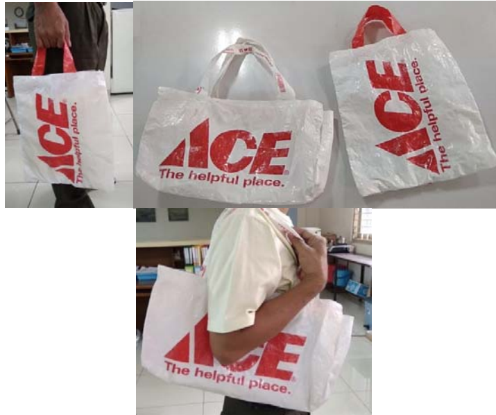
Gambar 16. Prototype Tas dari kantong kresek jenis HDPE dengan teknik pemanasan setrika
