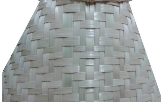
Gambar 3.2 Anyaman bilik yang dirubah polanya untuk menghasilkan bentuk melengkung.
