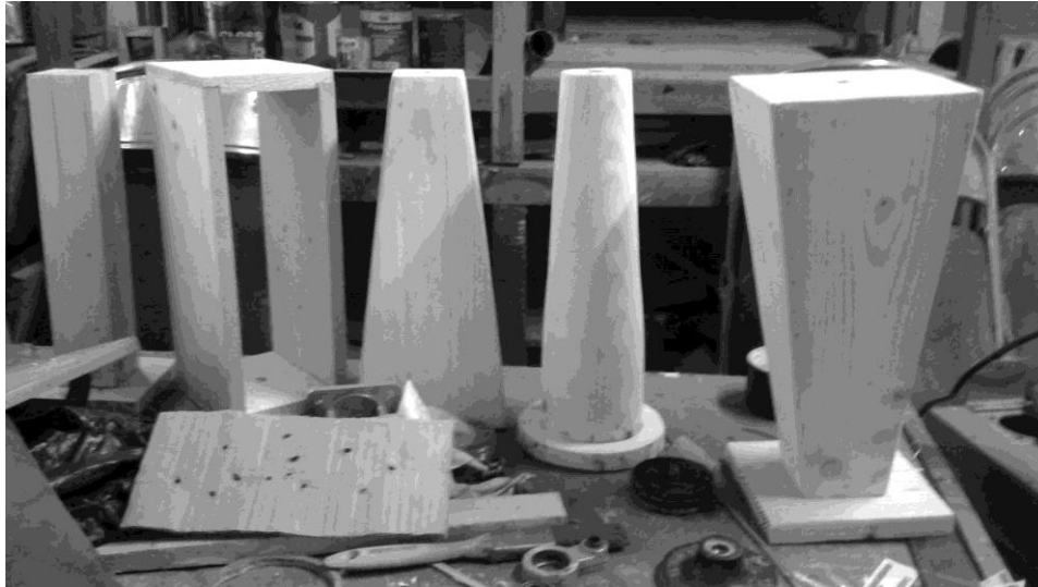
Gambar 4.2 Pembuatan dudukan (base) dari kayu
