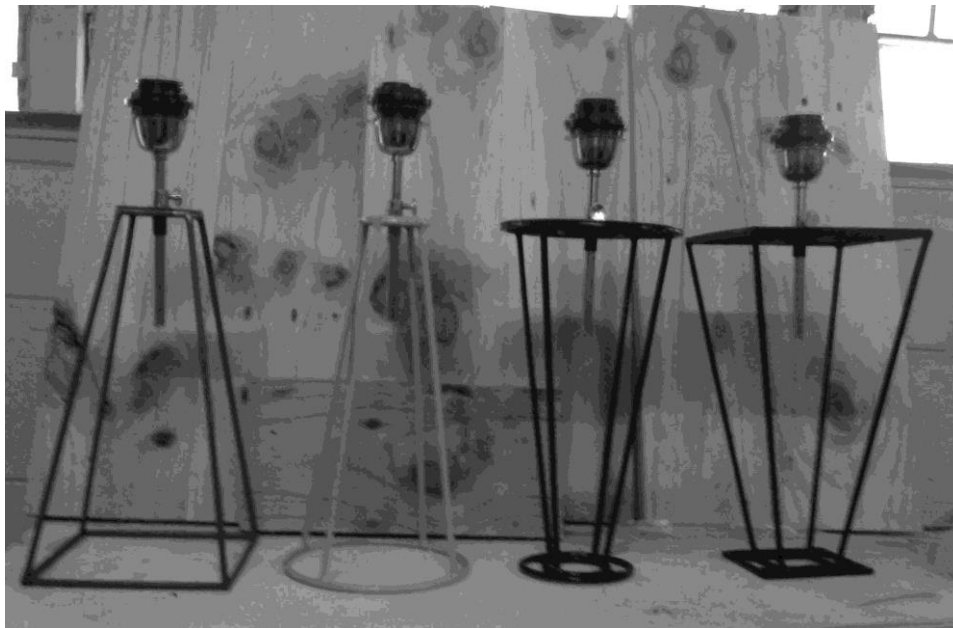
Gambar 4.3 Pembuatan dudukan (base) dari besi beton
