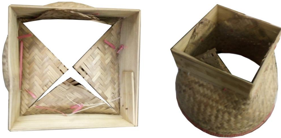
Gambar 3.9 Proses pembuatan lobang pada nagian bawah boboko.
