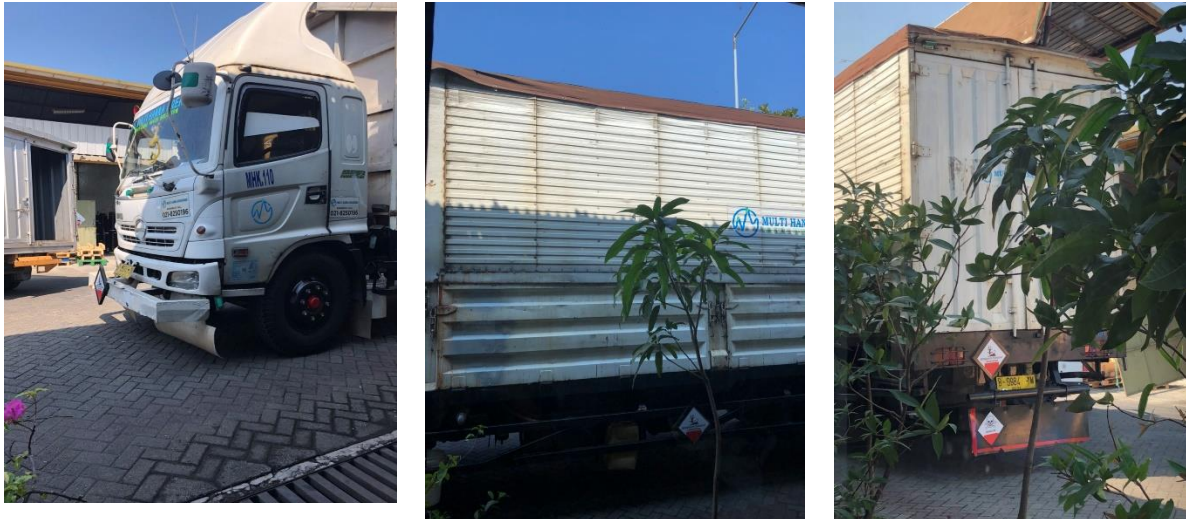
Gambar 4.23 Pelekatan simbol pada kendaraan pengangkut limbah B3 di Peruri Sumber: Hasil Dokumentasi, 2019
