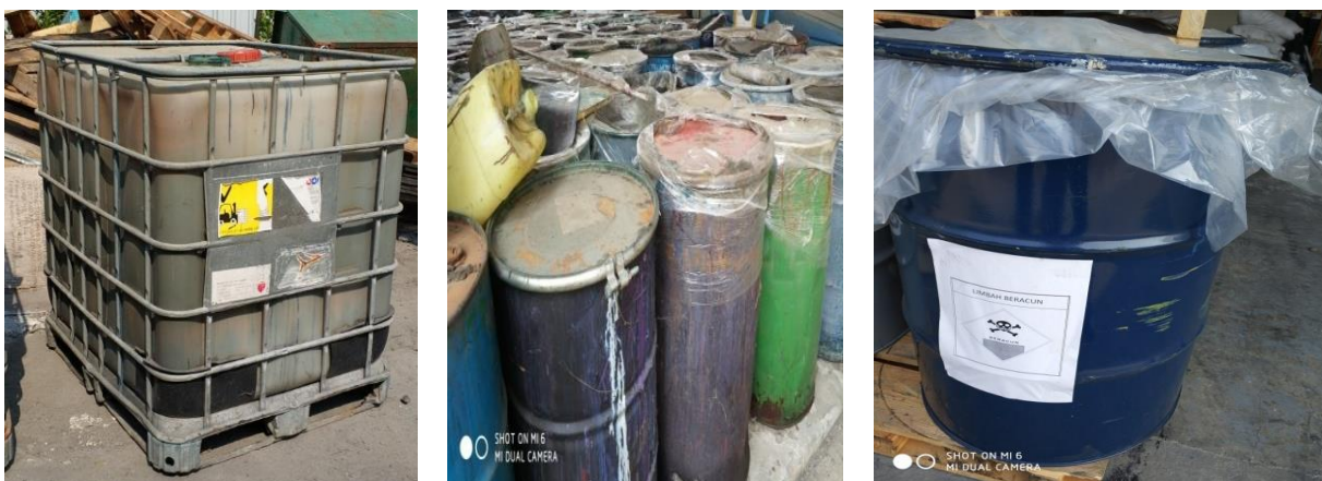
Gambar 4.21 Tidak Terdapat Simbol dan Label Pada Kemasan limbah B3 cair.
