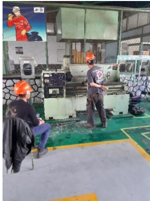
Gambar 5. 7 Proses cutting (pemotongan) material dengan mesin bubut
