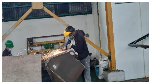
Gambar 5. 6 Proses cutting (pemotongan) material dengan mesin gerinda
