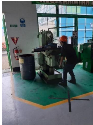
Gambar 5. 8 Proses cutting (pemotongan) material dengan mesin milling
