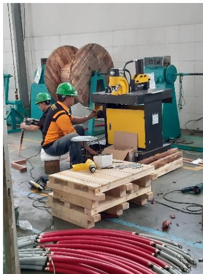
Gambar 5. 10 Proses bending (pembengkokan) material dengan mesin tekuk
