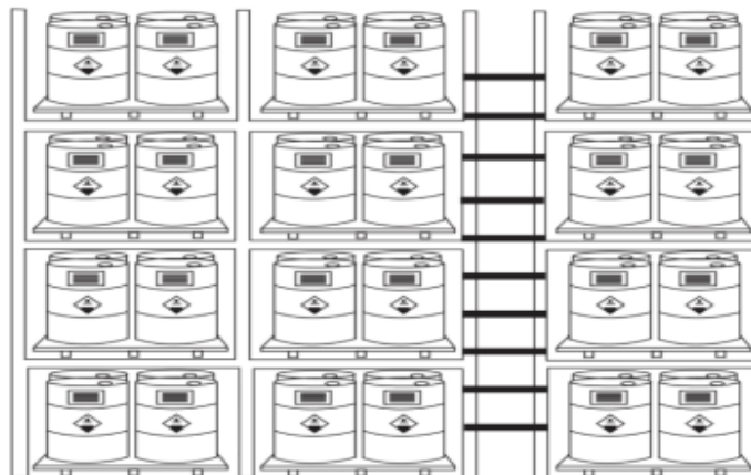
Gambar 2. 3 Penggunaan Rak pada Penyimpanan Limbah B3 dengan Kemasan Drum
