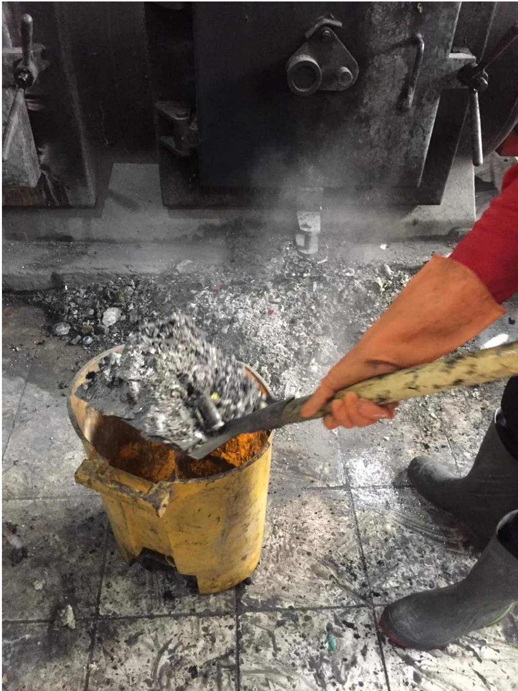
Gambar Proses Pengambilan Abu Insinerator
