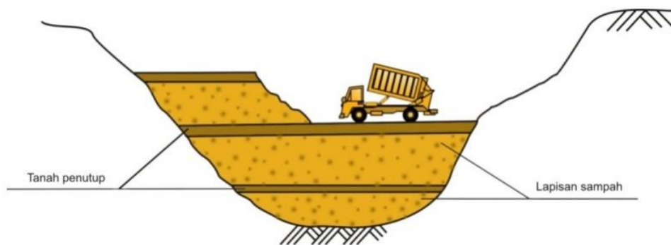
Gambar 2. 7 Pengurukan Sampah dengan Sanitary Landfill metode Sandwich
