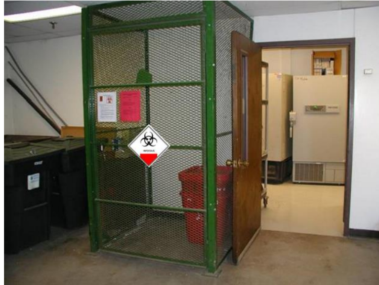
Gambar 3.1 Contoh Fasilitas Penyimpanan Limbah B3 dari Fasilitas Pelayan Kesehatan dalam Ruangan yang Dilengkapi dengan Pembatas Akses (kerangkeng)
