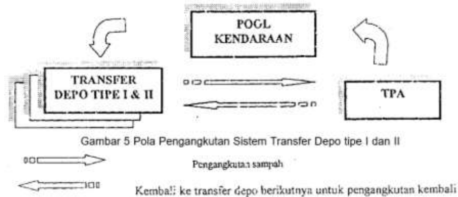
Gambar 3. 2 Pola pengangkutan sistem transfer depo tipe I dan II
