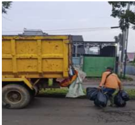
Gambar 4. 13 Sistem Kontainer Angkat (Hauled Container System, HCS) di Kecamatan Gading Cempaka
