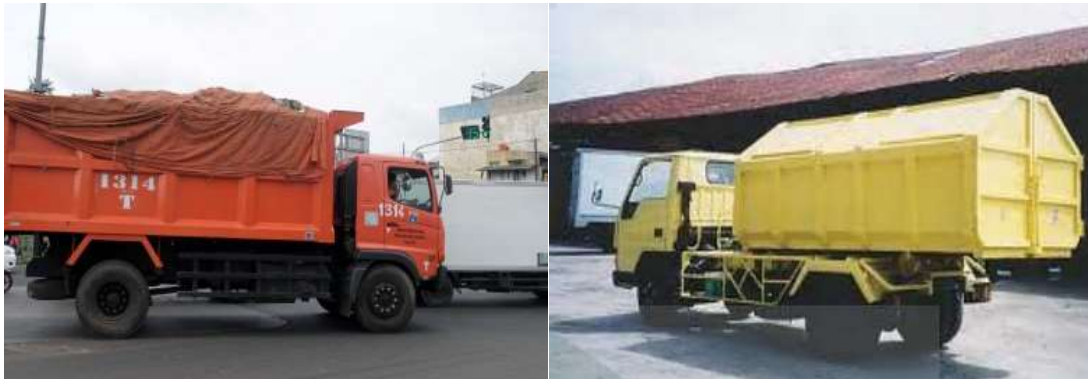
Gambar 4. 14 Truk sampah dengan bak tertutup yang dianjurkan
