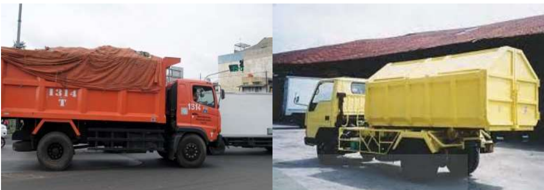
Gambar 4. 10 Truk sampah yang dipasang terpal dan truk sampah dengan bak tertutup
