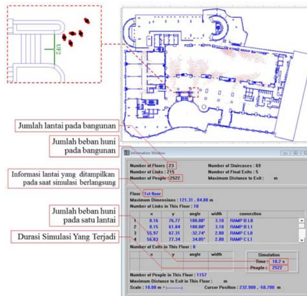
Gambar 4. Contoh Simulasi Pada Simulex Beban Hunian 100% Dari Kapasitas (Sumber : Uji Simulasi Pada Simulex )
