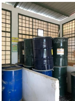
Gambar 4.38 Wadah Limbah B3 yang Tidak Terdapat Simbol
