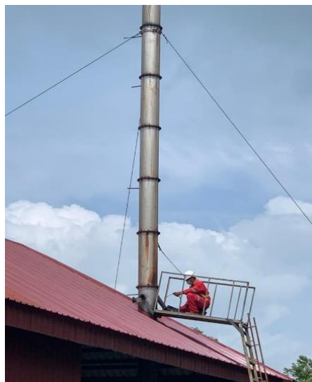
Gambar 4.34 Pengukuran Emisi Insinerator di RSBP Oleh PT. Surveyor Indonesia
