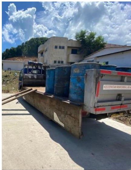
Gambar 4.39 Truk Pengangkut yang Tidak Dilengkapi Simbol Maupun Nomor Telepon Perusahaan
