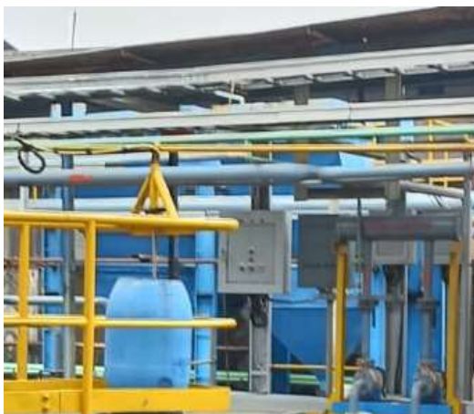
Gambar 5. 47 Lamella Separator di IPAL PT X
