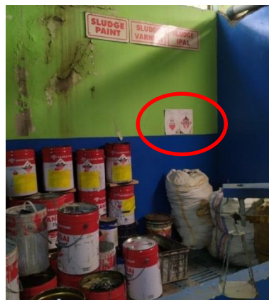
Gambar 4. 13 Simbol Limbah B3 pada Tempat Penyimpanan LB3 Sludge Painting , Sludge Varnish , dan Sludge IPAL
