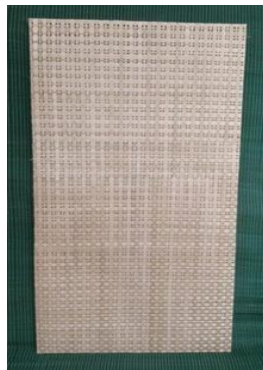
Gambar 18 (kiri atas) : komponen dasar berbentuk panil untuk di dinding interior dari anyaman bambu berukuran 60 cm x 60 cm yang bisa di tambahkan dalam konfigurasi sesuai dengan luas bidang dinding penempatan. Gambar 19 (kanan atas) : salah satu type anyaman bambu yang dipakai untuk komponen dasar panil dinding interior.
