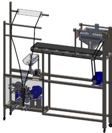
Gambar 8. Konsep Sistem Mekanik Mesin Packing Buncis Otomatis
