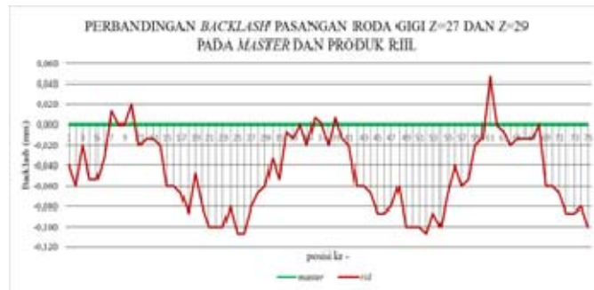
Gambar 6 Perbandingan antara backlash pasangan roda gigi master dengan riil
