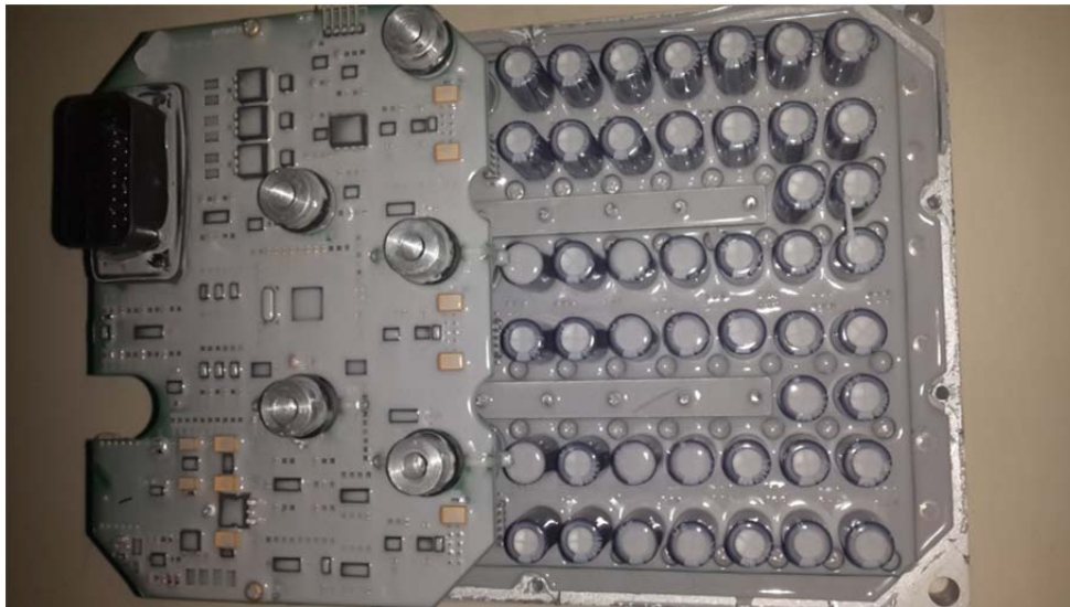
Gambar 5.8 Realisasi Kontroler motor BLDC
