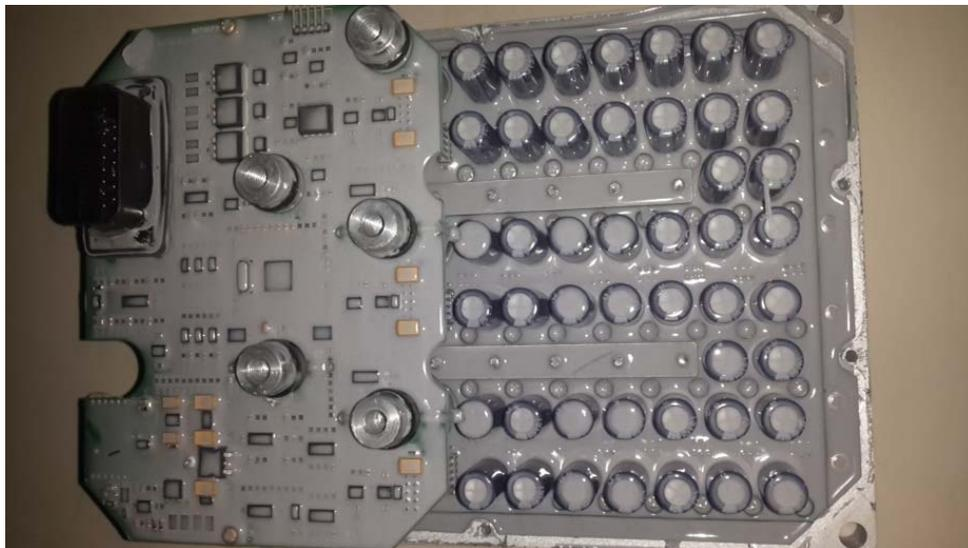
**Gambar 4.28** Realisasi Kontroler Motor BLDC
