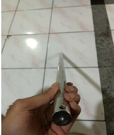
**Gambar 5.15** Hasil Pemotongan Poros as Pejal untuk *Rod Piston*
