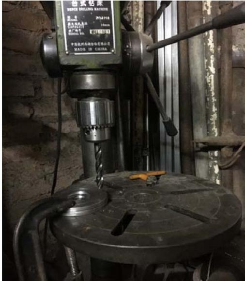
**Gambar 5.14** Proses *Drilling* pada Sambungan
