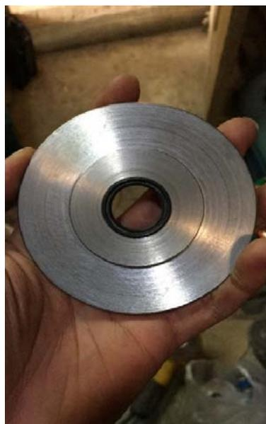
**Gambar 5.13** Pembuatan Dudukan *Seal* pada Sambungan
