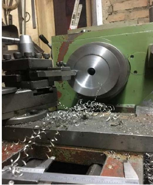
**Gambar 5.12** Proses Pembubutan pada Sambungan
