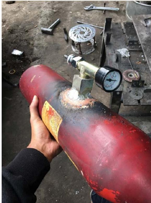
**Gambar 5.9** Hasil Pengelasan *Socket* ke Tabung
