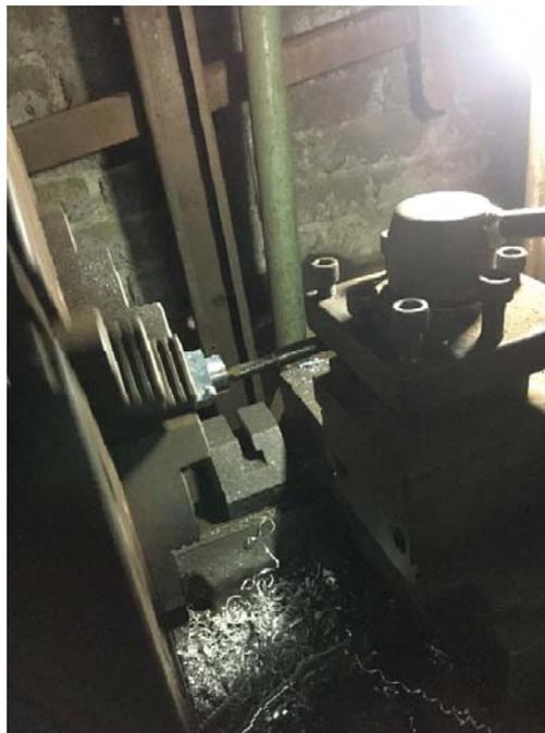
**Gambar 5.8** Proses Pembuatan *Socket* ke Tabung
