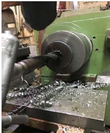
**Gambar 5.11** Proses *drilling* pada Sambungan
