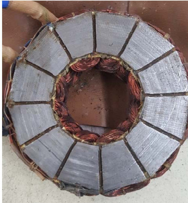
Gambar 3.1 Stator terdiri dari core and armature
