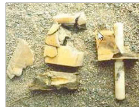
Gambar 7.19 - Angkur siar muai yang terlepas dari beton
