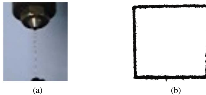
Gambar 4 (a) Aliran serbuk keluar nosel, dan (b) bentuk deposisi
