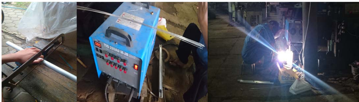
Gambar 2 Proses pemotongan dan pengelasan 80A, 100 A, 120 A
