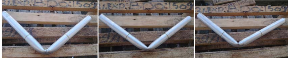
Gambar 5 Hasil pengujian bending untuk 80 A, 100 A, 120 A
