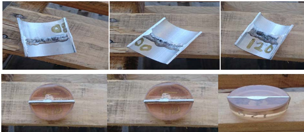
Gambar 6 Spesimen untuk pengamatan struktur mikro untuk 80 A, 100 A, 120 A
