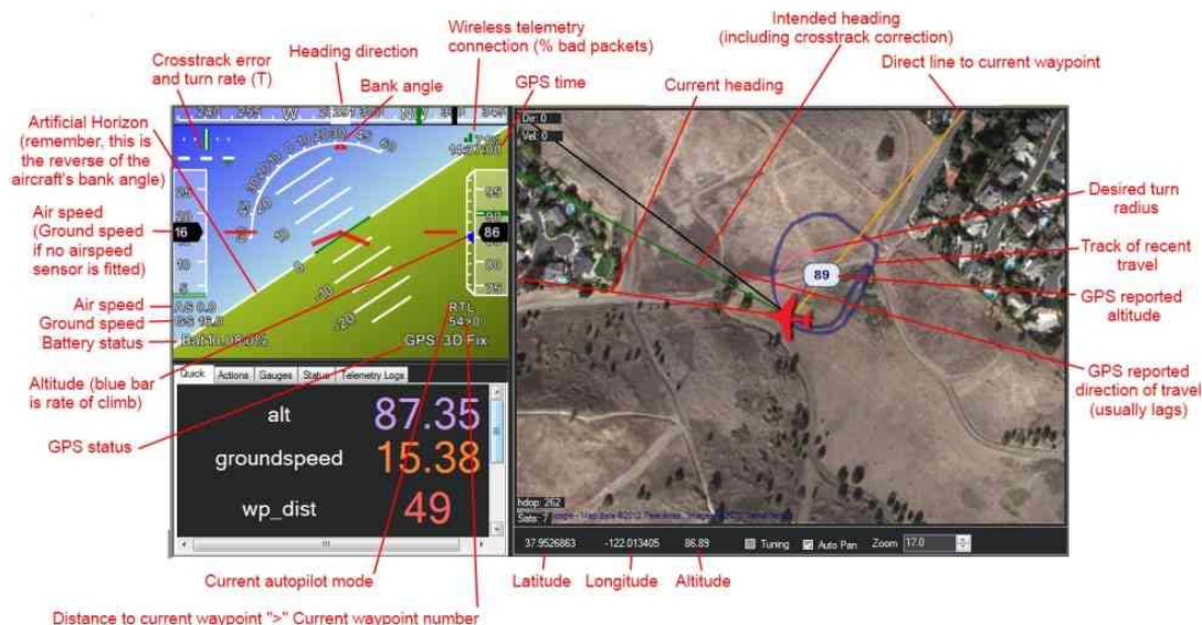
Gambar 7. Tampilan perangkat lunak Mission Planner [4]
