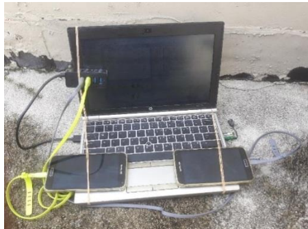
Gambar 3. Peralatan drive test indoor yang sudah terpasang
