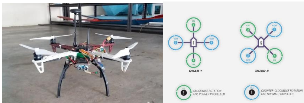
Gambar 2.(a) Quadcopter v3 yang memiliki kemampuan anti-collision; (b) konfigurasi rotor pada quadcopter tipe + dan quadcopter tipe x [3]
