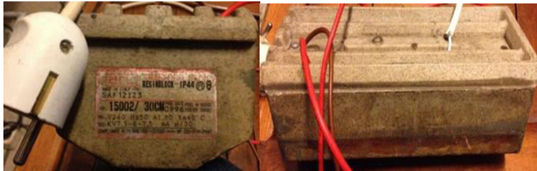
Gambar 2. Trafo Tegangan Tinggi
