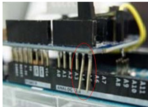
Fig.8: Pin A4 and A5 modifications on shield module.
