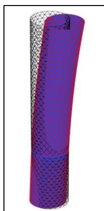
Gambar 3. Suction pile mengalami defleksi akibat beban lateral
