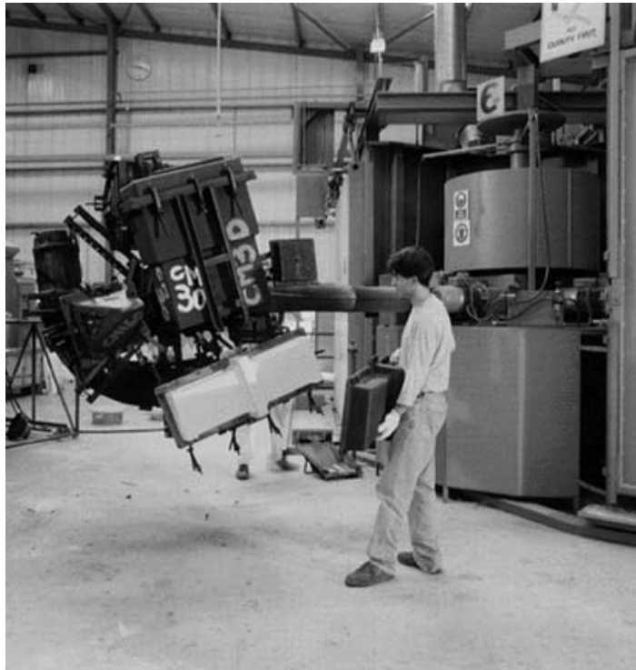
GAMBAR 820 Proses rotational moulding . Pada proses ini plastik dipanaskan dan didinginkan dalam keadaan berputar sehingga distribusi polimer akan merata.
