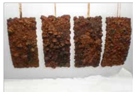
GAMBAR 3.29 Kupon sampel uji laju korosi.
