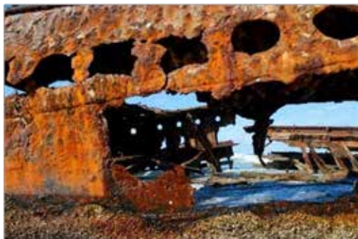
GAMBAR 3.27 Baja terkorosi sehingga terjadi kehilangan material.
