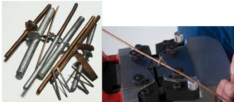
GAMBAR 6.49 Aplikasi pengelasan dingin pada kabel.
