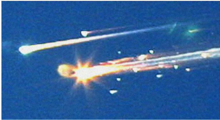
GAMBAR 10.5 Ledakan pesawat Columbia ketika memasuki atmosfer bumi pada 1 Februari 2003. Ledakan disebabkan karena kegagalan pada panel sayap Columbia yang terbuat dari komposit karbon-karbon. Penyebab kegagalan bukan karena komposit ini tidak mampu menahan panas, melainkan berlubang karena terkena busa saat lepas landas. Sebelumnya para ahli tidak percaya bahwa busa yang lunak dapat merusak komposit yang keras tersebut, namun setelah dilakukan penyelidikan maka terbukti bahwa energi impact yang besar dapat melubangi komposit karbon-karbon yang getas.
