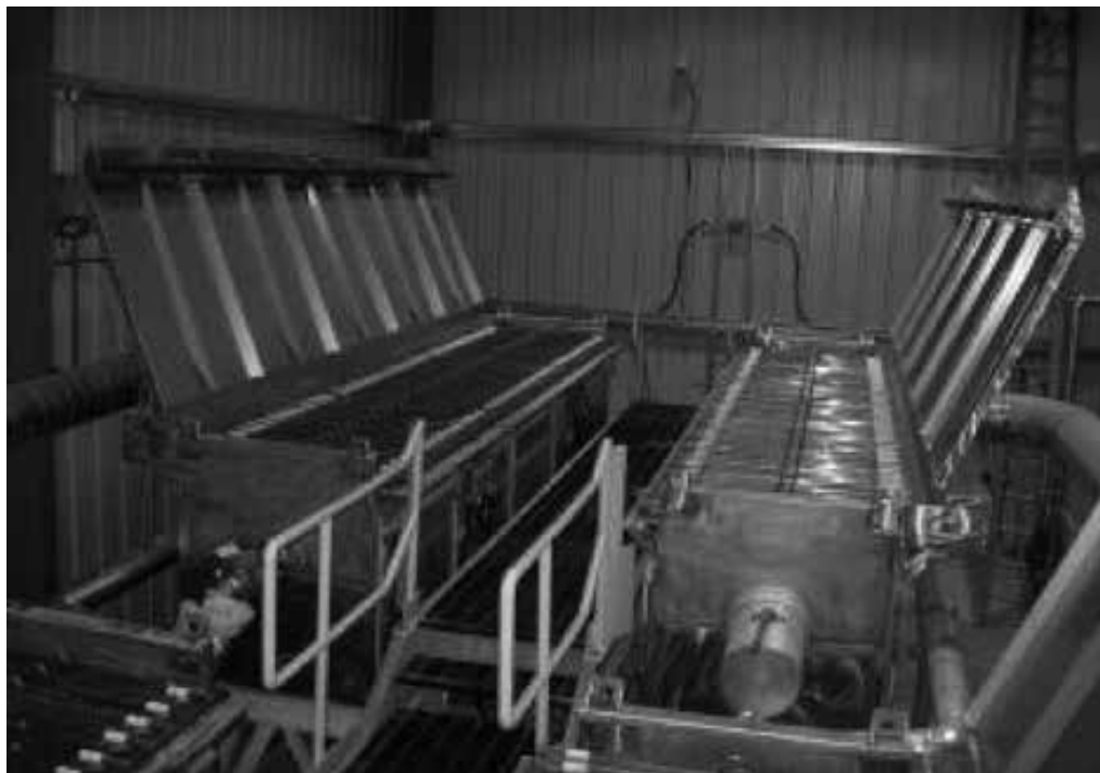
GAMBAR 5.13 Sel electrowining dalam proses perolehan logam emas.
