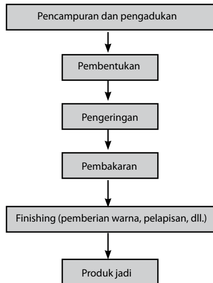
GAMBAR 9.27 Tahapan pemrosesan keramik dari lempung.
