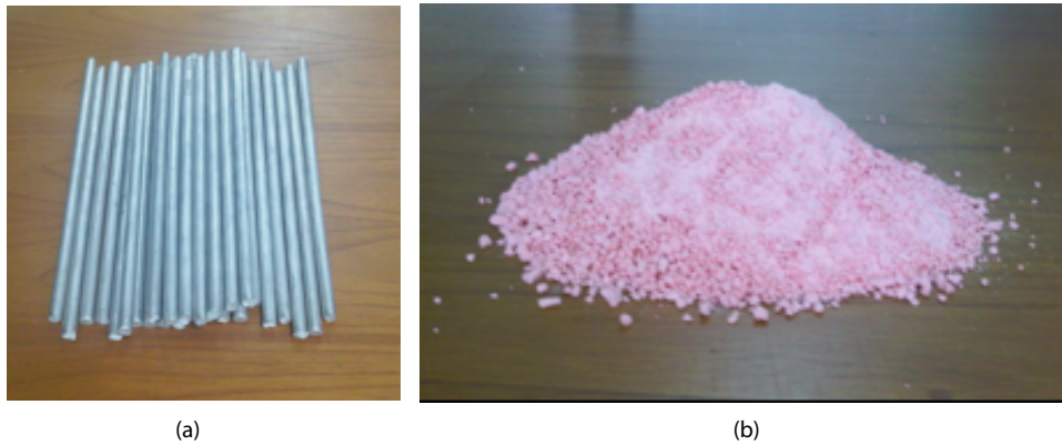
GAMBAR 7.7 Penghalus butir Al-Ti berbentuk (a) batang paduan dan (b) serbuk.
