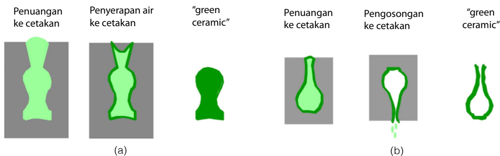
GAMBAR 9.29 Proses slip casting pada keramik (a) solid casting , (b) drain casting .
