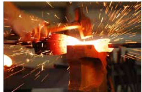
GAMBAR 6.16 Penempaan cetakan terbuka.
