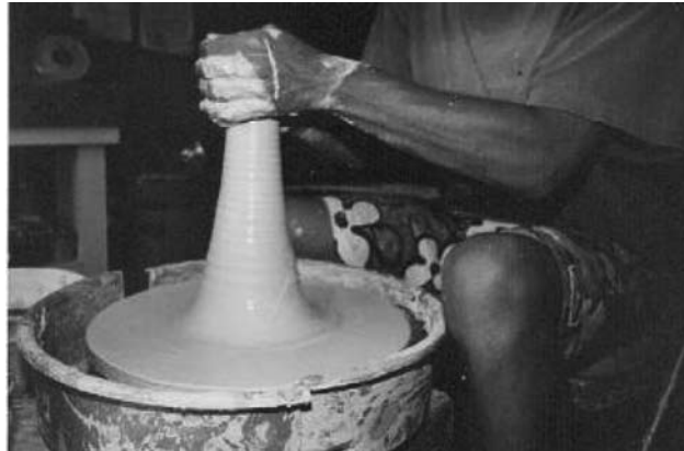
GAMBAR 9.28 Proses pembentukan hidroplastis keramik.
