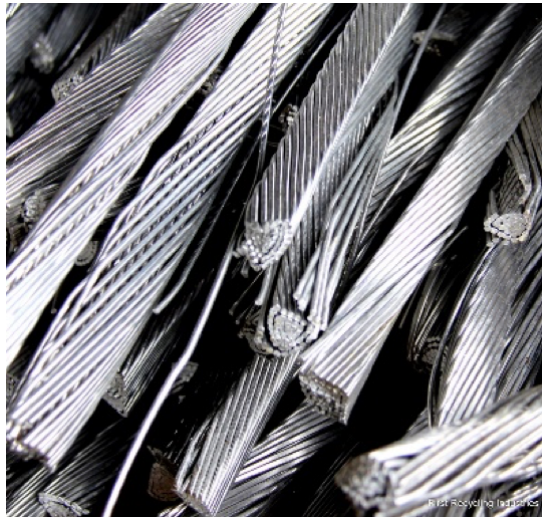
Gambar 11.16. Kabel listrik dari aluminium. Kabel aluminium ini biasanya dipakai untuk jaringan listrik tegangan tinggi.
