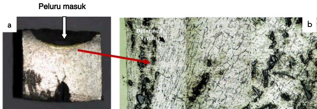
Gambar 10.3. Perforasi komposit Al7Si6Mg5Zn (% berat) dengan 10 % volum SiC yang dapat menahan peluru tipe II berkaliber 9 mm: (a) pengamatan makro, dan (b) struktur mikro yang menunjukkan butir aluminium yang terdeformasi dan partikel SiC yang mengelompok.
