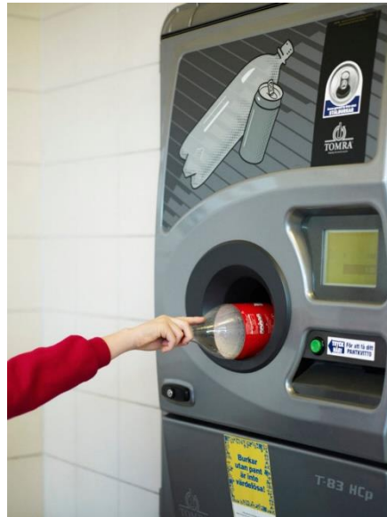
Gambar 2. 9 Mesin pengumpul botol plastik dan kaleng
