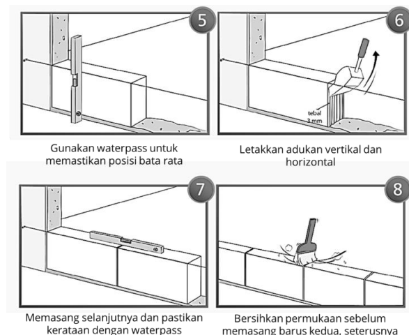
Gambar 2.7 Pemasangan Bata Ringan (Lanjutan)
