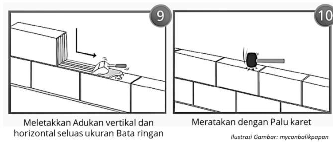
Gambar 2.8 Pemasangan Bata Ringan (Lanjutan)
